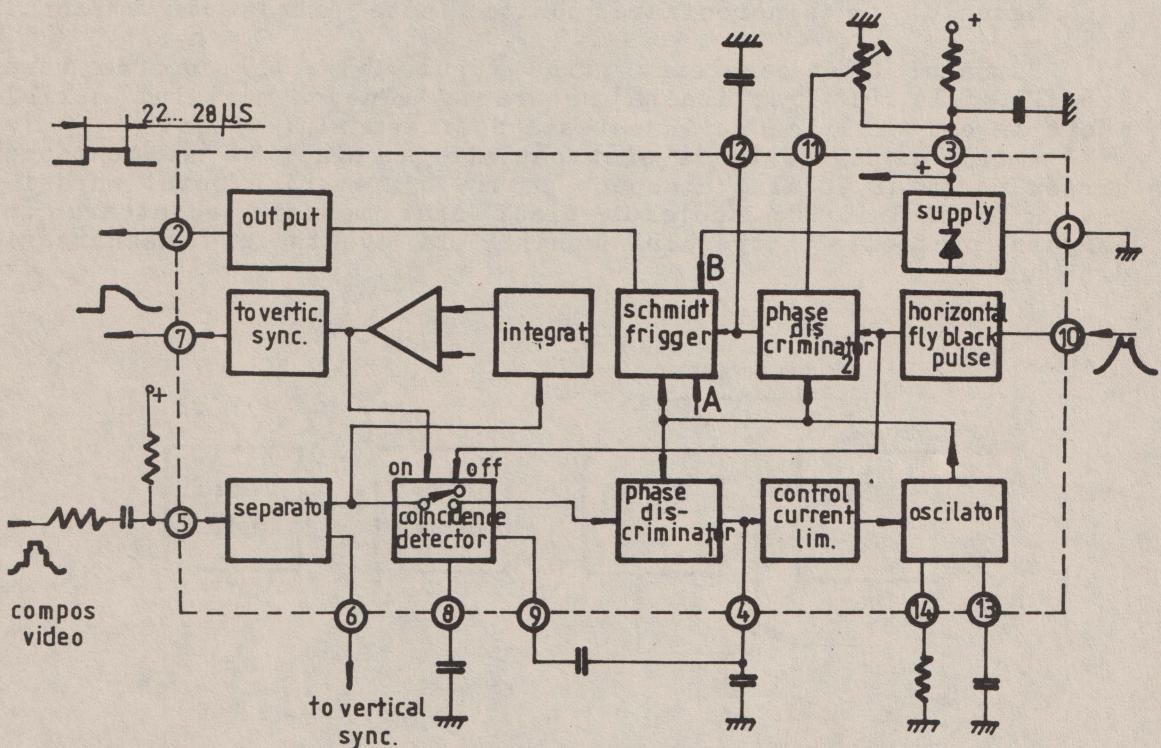
Cind lipsesc impulsurile de sincronizare a liniilor, oscilatorul intern are o frecventa libera de oscilatie a carei valoare este determinata de doua componente externe  $R7=10.5\text{ K}\Omega\text{m}$  1% si  $C6=10\text{ nF}$  2%, la  $15625\text{ Hz}$   $\pm 10\%$ .
